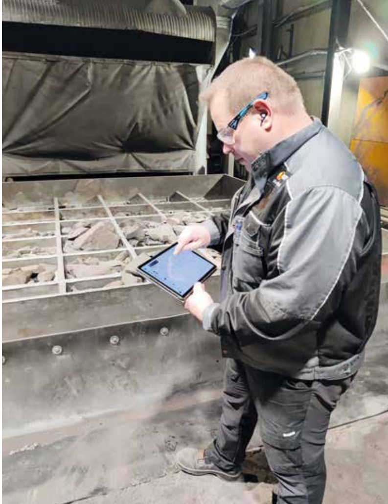
Mikko Räsänen tutkimassa tärypöydän moottorien lämpötilaa ja virrankulutussarvoja tabletilla.
