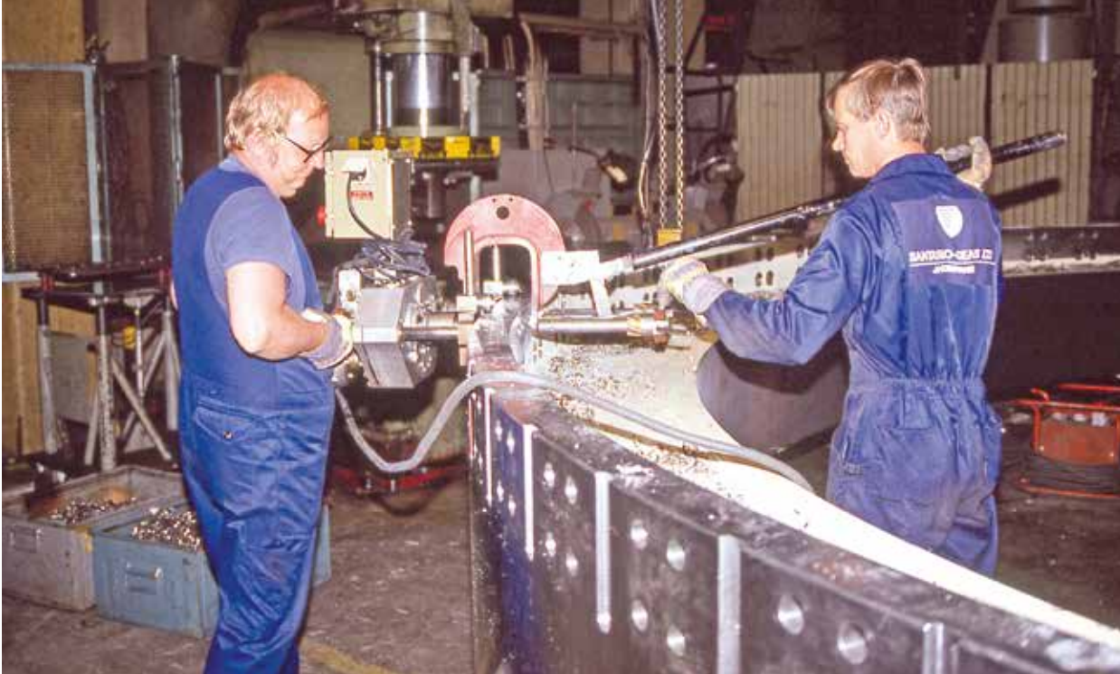
Valurautaisen hammaspyörän segmentin koneistusta Santasalon tehtaalla Karkkilassa 1980-luvun lopulla. Vasemmalta Martti Vauhkonen ja Osmo Kylmäkorpi. Reino Vesander/KRM
