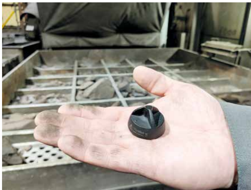
Neuron Vibration -anturi mittaa tärinää ja lämpötilaa – eikä ole pullonkorkkia suurempi.
