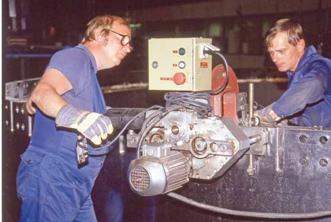
Martti Vauhkonen ja Osmo Kylmäkorpi koneistavat Santasalolla Högforsin valamaa hammaspyörän segmenttiä 1980-luvun loppupuolella. Reino Vesander/KRM
