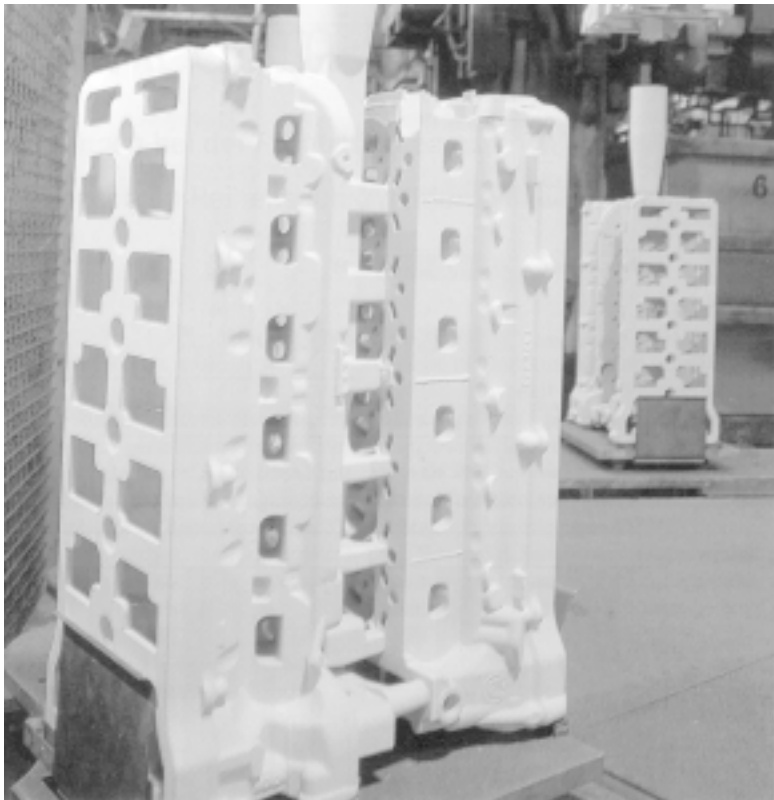
Kuva 8. Kaksi polystyreenistä valmistettua ja peitostettua BMW:n sylinterilohkon mallia sekä kaatokanava koottuna mallipuoksi.
