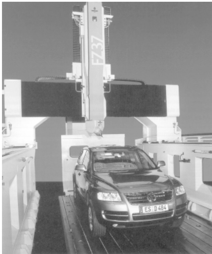
Kuva 5. Euromoldissa esitelty F.Zimmermannin CNC-portaaliyrsinkone.
