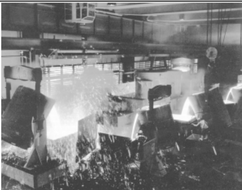
Kuva 10. Puristimen rungon muottiin valetaan 255 t sulaa rautaa viidestä senkasta Siempekkampin valimossa.
