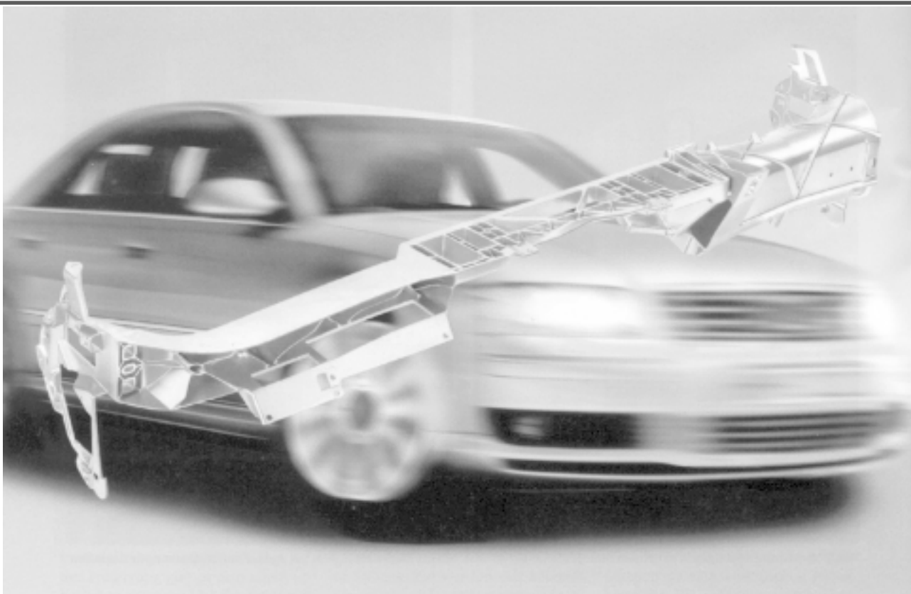
Kuva 6. Audi 8:n valettu kojetaulun tuki.
